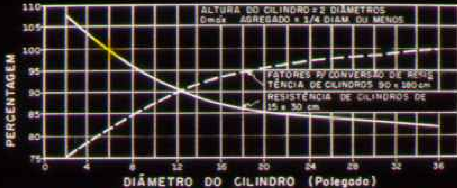
Figura 5.2.1.2 - Efeito do Tamanho do Cilindro na Resistência à Compressão do Concreto Concrete Manual
